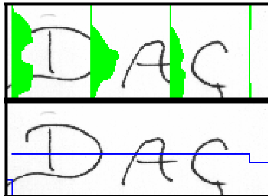
Figuur 3.4: De letter D heeft een projectiehistogram met een dal in het midden. Hierdoor wordt een regelovergang getekend die door de tekst heen snijdt.*
